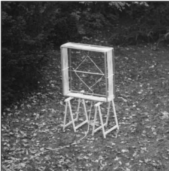
**Fig 7: Antena de cuadro de recepción de 137 kHz.**
