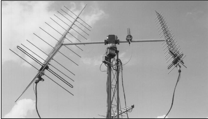
**Figura 6: 144MHz y Antenas 432MHz.**
